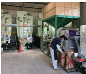
ミニライスセンター 乾燥機3台、粉摺り機、米選機、色選別機、計量機
